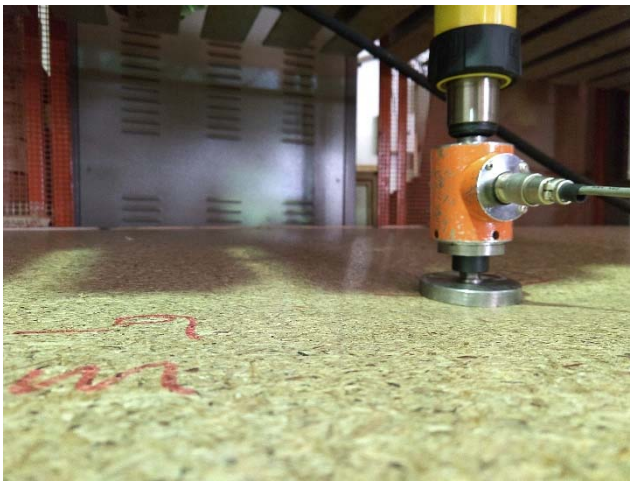
Figura 2: Ensayo de carga concentrada con borde apoyado. a) Esquema de aplicación de ensayo de carga concentrada en franjas de paneles según ASTM E-661. b) Implementación de ensayo de carga concentrada para panel completo. c) Sistema de rocío por una cara para humectación de panel.
