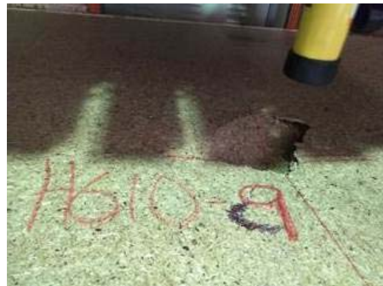
b) Probeta húmeda en la falla
