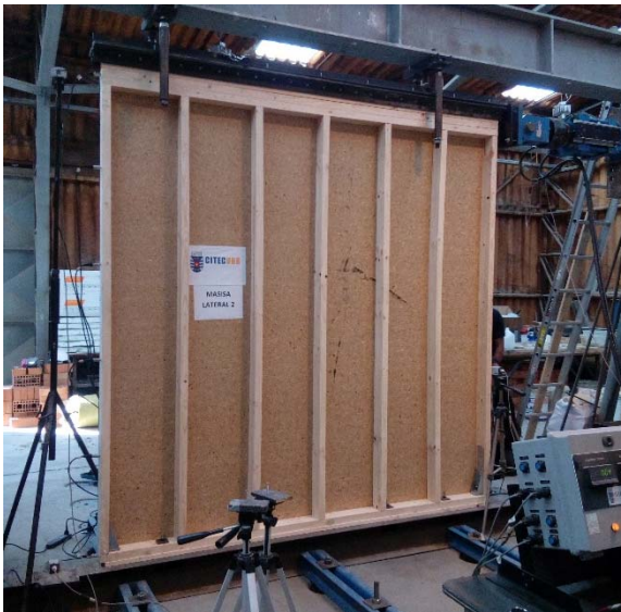
Figura 3: Ensayo de carga horizontal de muros con placa OLB. a) Esquema de fabricación de los muros. b) Vista de la implementación del ensayo. c) Anclajes al sistema de fundación.
