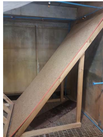
Figura 2: Ensayo de carga concentrada con borde apoyado. a) Esquema de aplicación de ensayo de carga concentrada en franjas de paneles según ASTM E-661. b) Implementación de ensayo de carga concentrada para panel completo. c) Sistema de rocío por una cara para humectación de panel.
