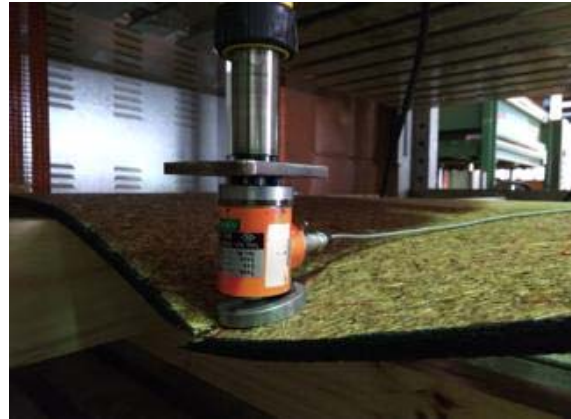
b) Probeta húmeda en la falla
