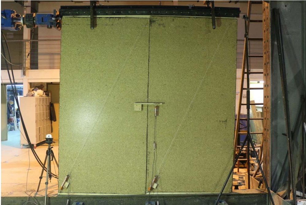
Figura 14: Giro de los tableros durante ensayo de carga horizontal
